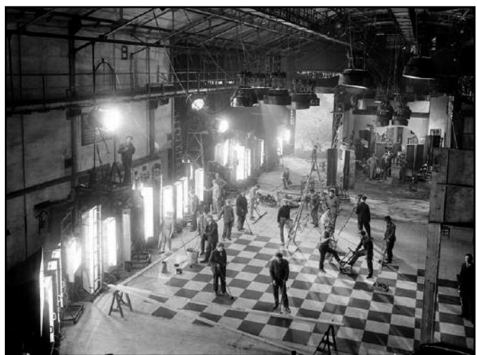
Eclairages à rampes de tubes à vapeur de mercure sur un plateau des studios Cinéroman à la fin des années 1920
