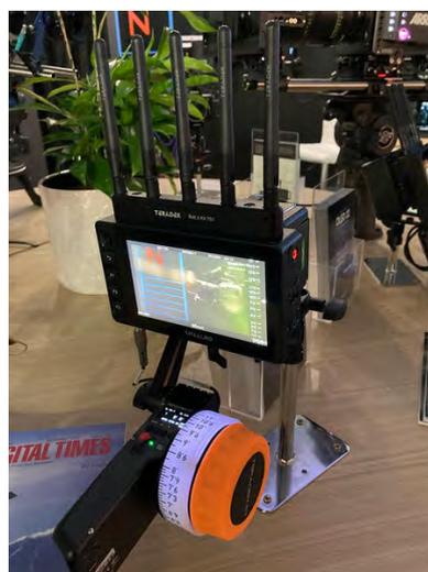
Moniteur SmallHD monté sur une commande de point Teradek et le système de transmission sans fil
