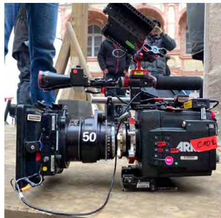
L'Alexa Mini LF avec le 50 mm Série C, configuration de base pour les scènes d'action
