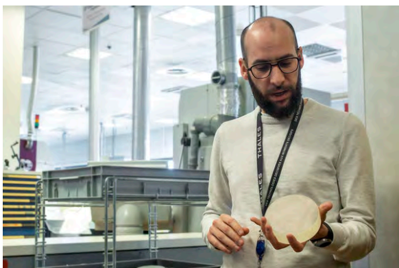
Vincent Collin et un bloc de verre optique brut avant les étapes d'usinage et de polissage
