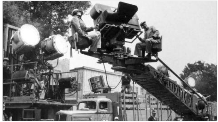
Tournage de Bwana le diable en 1952, avec le dispositif 3-D dit NaturalVision : deux caméras Mitchell face-à-face
