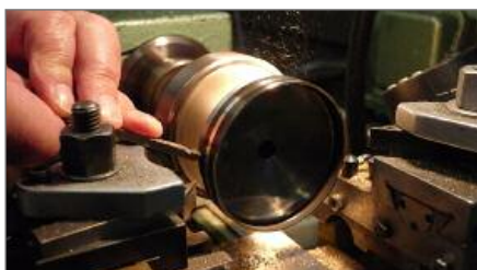
Rectification au tour d'un support de lentille après son centrage - Photo Nathalie Durand
