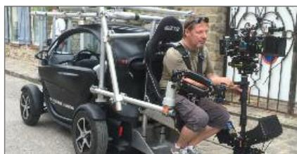
La TwizyCam est aussi suffisamment compacte pour être transportée dans une camionnette qui contient par la même occasion tous les accessoires de rig : tubes aluminium, plateforme et accessoires pour le toit, sièges optionnels pour embarquer deux techniciens supplémentaires à l'avant ou l'arrière de la voiture...
