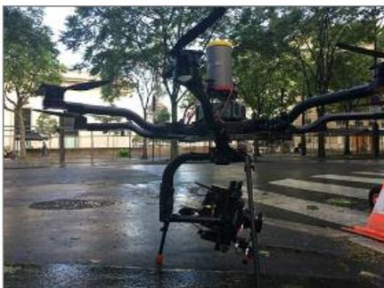
Drone Alta 8 avec parachute de sécurité
