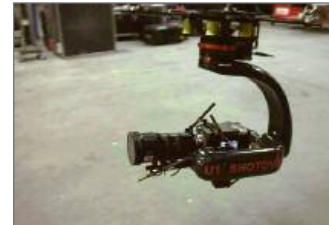
Cablecam 2 axes avec Shotover G1
