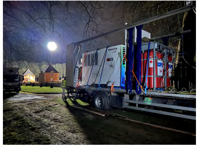
Le générateur électro-hydrogène GEH2® de 100 kVA sur le tournage d'"Arsène Lupin" saison 3 dans le parc du château de Courances
