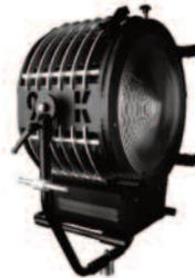
C'est le dernier né de la gamme Fresnel proposée par K5600 Lighting. Il dispose des mêmes caractéristiques que les autres projecteurs de la gamme (Alpha 1600 W – Alpha 4 kW – Alpha 18K). Sa lentille de Fresnel amovible, de 450 mm, permet une focalisation de 10° à 60°, d'un faisceau propre et contrôlable. Sans cette lentille, nous retrouvons l'Open Face distinctif des Alphas, créant ainsi un faisceau étale de 80° pour des ombres
