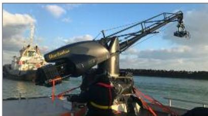
Le Russian Arm VI est le bras robotisé le plus performant et le plus fonctionnel du marché. Déjà gyrostabilisé sur deux axes (pan et tilt), le bras s'accompagne de la tête gyrostabilisée sur 3 axes Flight Head V. Cette combinaison permet d'éliminer toutes les secousses et vibrations et offre ainsi aux équipes de tournage la possibilité de capturer des séquences très dynamiques proches de leurs sujets,
