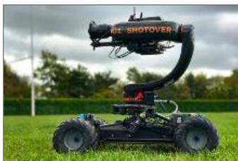
du rail de travelling traditionnel, et, de plus, il est tout terrain. Discret et compact, le Mantis et la Shotover G1 se contrôlent en HF (l'absence de câble étant un plus lors des tournages) et bénéficient d'une gyro-stabilisation haute performance sur 3 axes. Cet outil se rendra vite indispensable lors de vos tournages de fiction et captations live.
