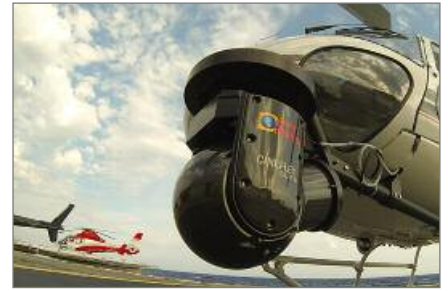
Le système Cineflex Elite monté sur le nez d'un hélicoptère - DR
