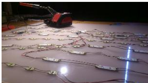
Mise en place et câblage des LEDs sur le panneau de fond de la photo " Gold rush "
