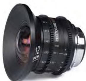
Le nouveau Laowa 12 mm t/2,9 Zero-D Cine est une version repensée et adaptée pour les cinématographes de l'objectif photo Venus Optics 12 mm f/2,8 Zero-D. Il est composé de 16 éléments répartis en 10 groupes dont deux lentilles asphériques. Son cercle d'image de 47 mm couvre les capteurs plein format et les plus grands capteurs VistaVision des caméras de cinéma telles que les caméras RED Monstro, Arri Alexa LF et Sony Venice.
