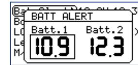
Aaton préconise une valeur de 10.8V dans le cas d'utilisation de batteries NiMh et entre 13,2V et 14V dans le cas d'utilisation de batteries Lithium-Ion. Pressez le bouton «Exit» ou «Set» pour sortir du menu.
