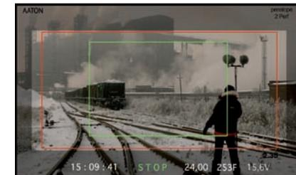
Pressez le bouton “Exit” pour revenir au menu **Frame Menu**. Procédez de la même façon pour modifier la partie inférieure et droite du cadre sélectionné via le sous-menu **Frame bottom right**. Le cadre vidéo peut être utilisé sans restriction pour surligner les cadres du dépoli caméra mais aussi pour isoler une partie de l’image durant le tournage.
