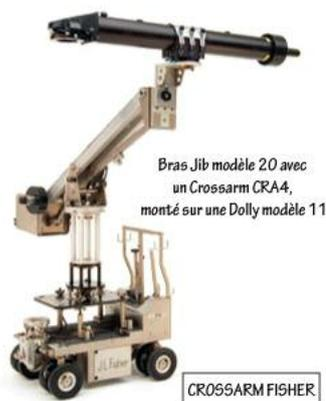
Bras Jib modèle 20 avec un Crossarm CRA4, monté sur une Dolly modèle 11
