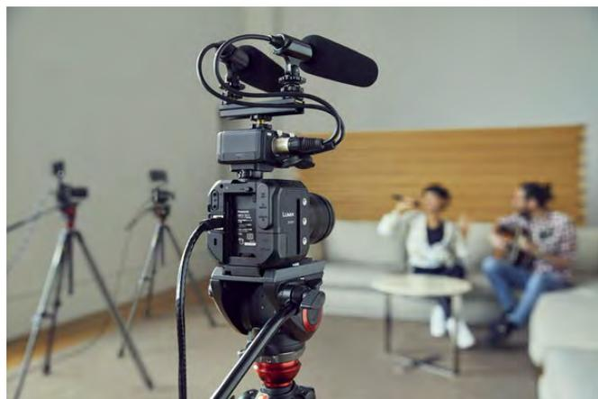
La Lumix BGH1 est une caméra compacte et légère de forme cubique, avec alimentation Power over Ethernet (PoE+), qui est extrêmement facile à installer. Le contrôle simultané d'un maximum de douze caméras Lumix BGH1[2] est possible grâce au logiciel Panasonic Lumix Tether pour Multicam[3]. Avec la future mise à jour du logiciel, il prendra également en charge le streaming IP filaire (RTP/RTSP).
