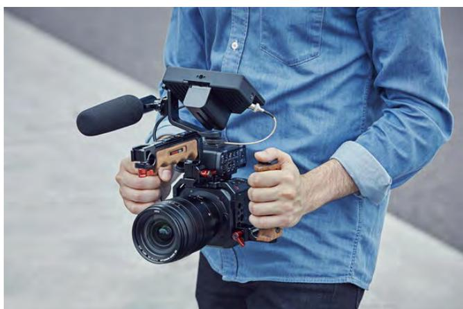
La Lumix BGH1 permet l'enregistrement vidéo 4:2:0 10 bits C4K/4K 60p/50p en interne. La caméra enregistre également avec une courbe gamma compatible ITU-R BT.2100 et permet de choisir le Hybrid Log Gamma (HLG) pour une captation en HDR. L'enregistrement sera alors possible en C4K/4K HEVC/H.265.
