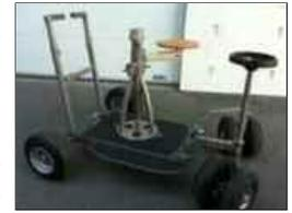
Sa version étroite lui permet d'évoluer dans les espaces les plus petits. Elle peut aussi monter sur rails travelling droits grâce à ses boggies spécifiques. L'embase pivotante avec les sièges et les accessoires peut se monter ou se démonter très rapidement.
