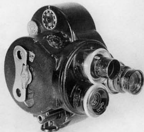
Abb. 2: Eine Eyemo Model-O mit dreifach Revolver.
