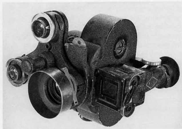
Abb. 1: Eine Eyemo 35 mit Spyder und dem grossen Seitensucher mit Parallaxenausgleich. Deutlich sichtbar der Filterschacht für Gelatine-Filter.
