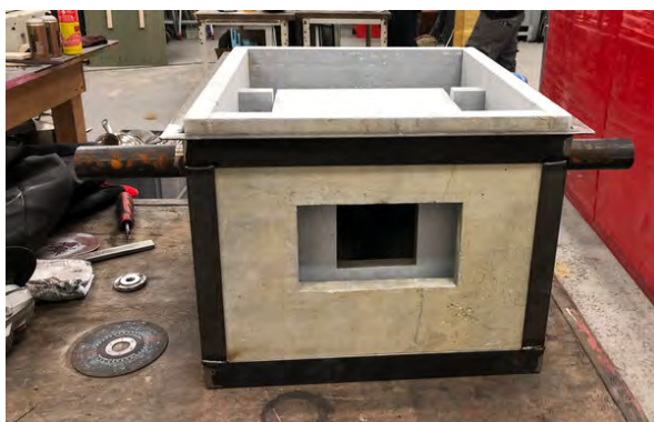
Assemblage caisson caméra anti-feu Photo Jean-Marie Dreujou
