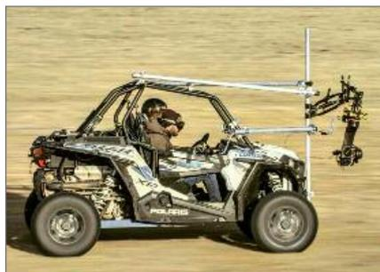
La tête gyro-stabilisée Shotover G1, peut-être installée sur gamme variée de supports, ici sur bombardier (véhicule travelling tout terrain)
