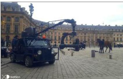
L'étroitesse du véhicule (142 cm de largeur pour 335 cm maximum de longueur lorsqu'il est surmonté du Mini Russian Arm) a offert encore une fois, une maniabilité indéniable au travers des ruelles étroites du quartier de Montmartre. Facile à manipuler grâce à son adaptabilité, le véhicule a également permis un tournage en toute sécurité sur la célèbre place Vendôme.
