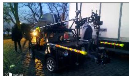
Le Mini Moke homologué pour la route est aussi disponible à la location sans le Mini Russian Arm. Il a été prouvé, durant ce tournage, qu'il était capable de tourner dans d'autres dispositions : ici, le véhicule a été utilisé surmonté d'une Mini Flight Head au bout d'un Black Arm et est parvenu ainsi se faufiler et se fondre dans la dense circulation parisienne.
