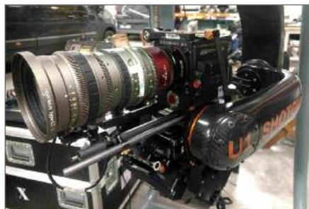
Tête gyro-stabilisée Shotover G1 équipée de la Red Monstro et d'une optique Angénieux 48-130 mm
