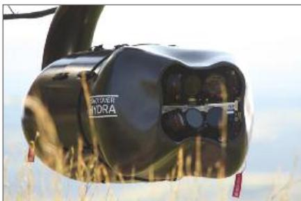
Il est possible de filmer pendant 30 à 60 minutes. Chaque caméra possède sa propre carte précisément identifiée par sa position dans l'Hydra. Un des avantages de ce système est que le "package" de caméras est déjà préinstallé, ce qui réduit fortement le temps dédié au paramétrage de la position des capteurs et à l'alignement des caméras et la production s'affranchit de la contrainte de louer séparément les caméras. Les optiques 24 mm sont également incluses.
