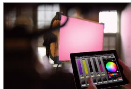
Photo 1 - Pilotage d'un projecteur DMX via un iPad
