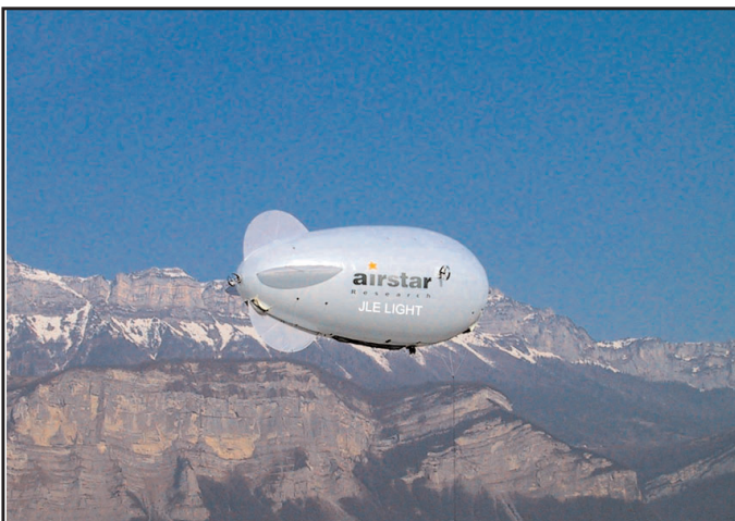
Ballon Aerial Work Station Ce ballon en forme de Zeppelin est motorisé et télécommandé à distance. Il peut transporter caméras, appareils photo ou tout autre appareillage. Une version différente est utilisée par Nicolas Hulot, sans moteur, mais équipée de rames.
