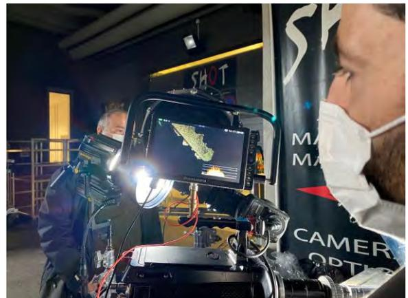
Phantom Flex 2K avec optique InfiniProbe™ TS-160 Universal - Projecteur Dedolight HMI 400 W, lentille de faisceau parallèle (DPBA 14-19) et réflecteurs Dedolight.
