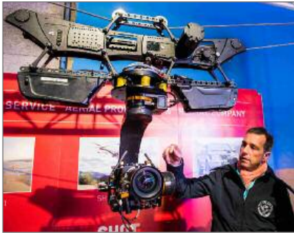
Aercam et tête gyrostabilisée Shotover G1 avec Camera Sony F55 et optique Angénieux 16-40 mm
