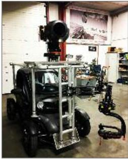
Présenté au Micro Salon, la Twizy Cam est un véhicule pratique et 100 % électrique spécialement adapté pour vos prises de vues film. Très compacte (1,25 m d'empattement seulement) et modulable, c'est l'outil idéal pour réaliser
