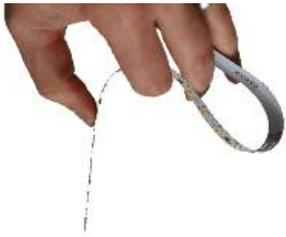
ezLED est un système d'éclairage "façon Légo" composé de modules LED (réglables de 336x18 mm), de circuits de connexion et de connecteurs permettant un raccordement rapide et sans soudure. ezLED séduit par la simplicité de mise en œuvre (aucune soudure n'est nécessaire), le faible échauffement thermique pour une forte puissance (30 W/m) qui permet d'intégrer la lumière dans les décors sans dissipateur additionnel. La flexibilité mécanique des barrettes permet une adaptation à toutes les formes.
