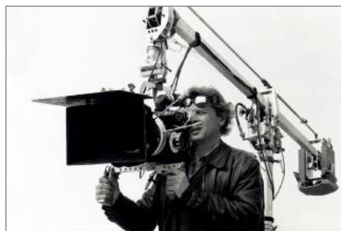
Patrick Grandperret sur le tournage, au Maroc, de L'Enfant lion , en 1993. Arri BL 35 suspendue au pantographe à vérins hydrauliques conçu par Ben Fauveau - Photo Olivia Bruynoghe
