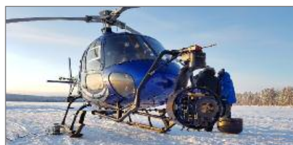
Tête gyro-stabilisée Shotover K1 embarquant une Alexa 65 et une optique Arri DNA
