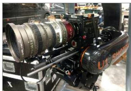
Tête gyro-stabilisée Shotover G1 équipée de la RED Monstro et d'une optique Angénieux 48-130 mm
