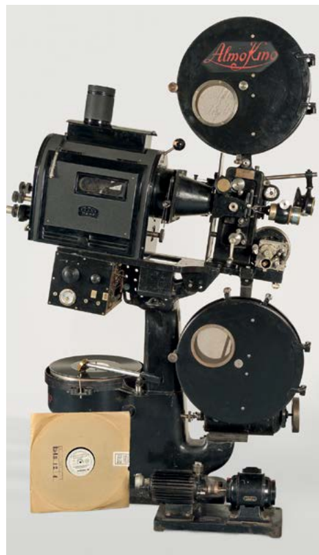
Projecteur 35 mm sonore équipé d'un lecteur de disque type Vitaphone et d'un lecteur de son optique type Movietone, Rotterdam, c. 1929. Collection CNC, photo Stéphane Dabrowski.
