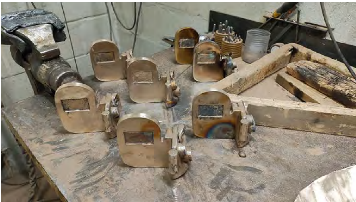
Exemplaires en bronze sortis du moule, en attente d'être nettoyés, ciselés et patinés Photo Luc Harzé
