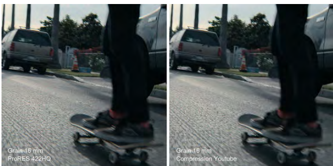
Cet exemple met en évidence le côté aléatoire de la restitution de la texture dans l'image. Les diverses valeurs d'aplat sur la portière de la voiture à droite cadre sont en contradiction avec la restitution de l'asphalte
